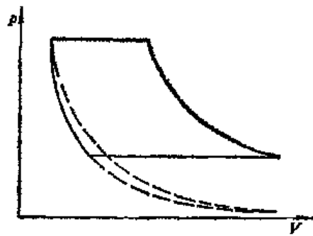
图 13-3 切断进气调节指示图 实线—全排气量时 虚线—切断进气调节时
